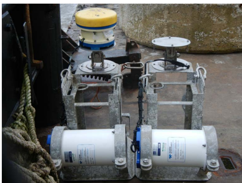
Figuur 2: Meetopstelling met de mogelijkheid tot het verticaal plaatsen van de ADCP
