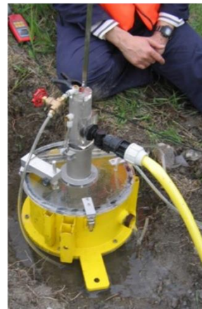
Figure 1. Essai de JET en laboratoire (à gauche) et essai de JET in-situ (à droite).
