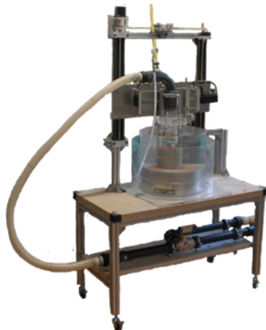
Figure 1. Essai de JET en laboratoire (à gauche) et essai de JET in-situ (à droite).
