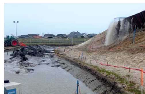
Figuur 8 – Bezijken van constructief versterkte proefdijk.
