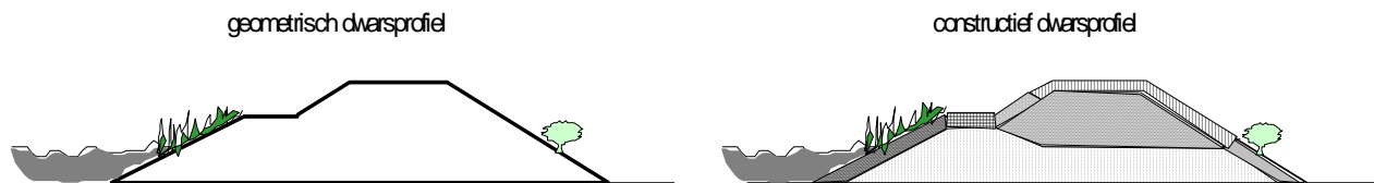
figuur 3.3: Verschil tussen het geometrisch dwarsprofiel en het constructief dwarsprofiel
