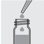
2,0 ml Probe **vorsichtig** in die Küvette pipettieren, mit Schraubverschluss verschließen und kräftig mischen.
