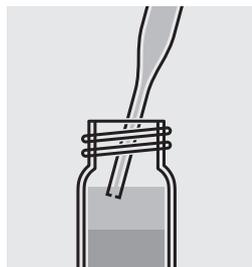
Aspirate the clear upper phase using a Pasteur pipette.
