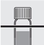
Küvette aus dem Thermoreaktor nehmen und im Küvettenständer abkühlen lassen.
