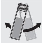
Bodensatz in der Reaktionsküvette durch Schütteln in Schwebe bringen.
